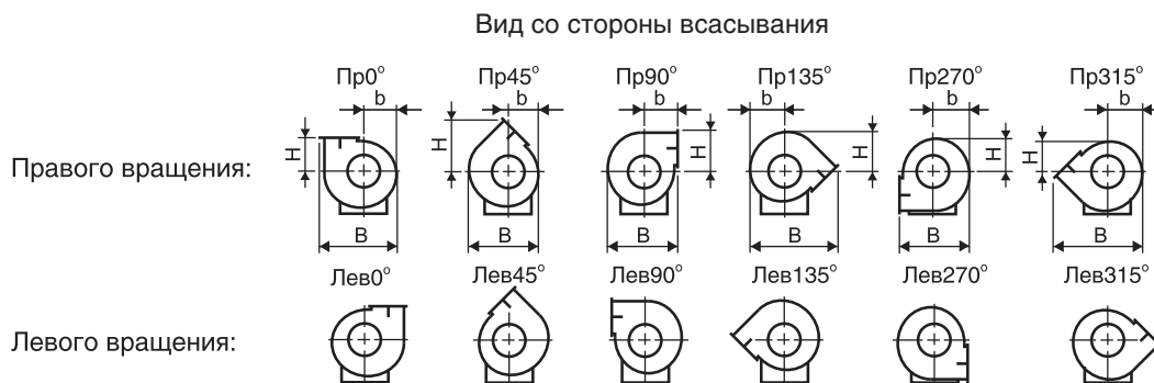
Рис. 1. Положение корпусов вентиляторов
